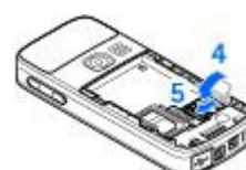
5. Inserire la batteria, quindi attaccare il cover posteriore sul dispositivo.
