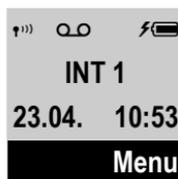
Ist der Modus **Strahlg. aus** (→ S. 20) aktiviert, wird im Display oben links das Symbol angezeigt.
