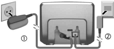
**Zuerst** Steckernetzgerät (230 V) mit Netzkabel ① und **danach** Telefonstecker mit Telefonkabel ② wie gezeigt anschließen. Die Kabel in die Kabelkanäle einlegen. Beide Kabel müssen **immer eingesteckt** sein.
