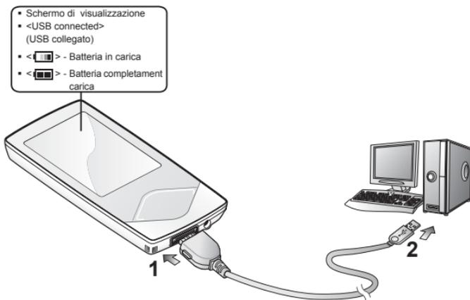
1. Collegare l'estremità più larga del cavo USB alla porta di connessione USB sulla base del lettore.
