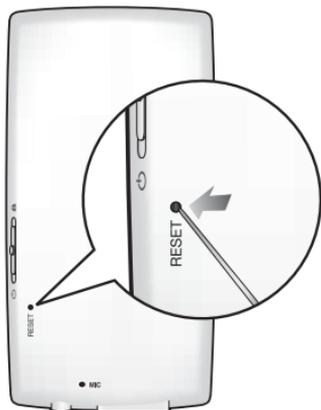
Premere il Foro di reset sulla parte inferiore del prodotto con un oggetto appuntito, come ad esempio un fermaglio.
