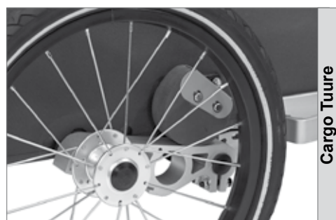
Suspension sans entretien AirPad® en Sylomer® (Cargo Tuure)
