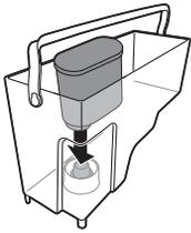
**17** Führen Sie den AquaClean-Filter senkrecht auf den Filteranschluss. Schieben Sie den AquaClean-Filter ganz nach unten. Kontrollieren Sie, dass der Filter dicht ansitzt und die Dichtung richtig sitzt, damit beste Ergebnisse erzielt werden.
