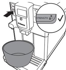
9 Stellen Sie einen Behälter unter den Heißwasserauslauf. Drücken Sie die OK-Taste, um den Wasserspülzyklus zu starten. Die Maschine erinnert Sie, dass Sie den Heißwasserauslauf in die Maschine setzen und dann die OK-Taste drücken müssen.
