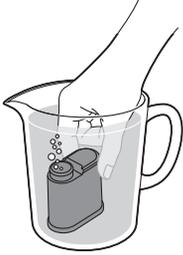
**16** Setzen Sie den AquaClean-Filter kopfüber in einen Behälter mit kaltem Wasser, und warten Sie, bis keine Luftblasen mehr austreten.
