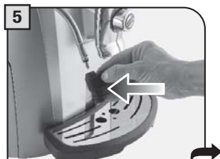
5 Estrarre e lavare il supporto del tubo vapore; dopo reinserire.
