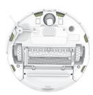
2 Reinigen Sie die Ladekontakte am Roomba und an der Home Base mit einem sauberen, trockenen Tuch
