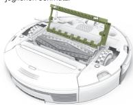
2 Entnehmen Sie auch die Gummi-Extraktoren und entfernen Sie die Endkappen. Entfernen Sie jegliches Haar oder Schmutz, das sich unter den Kappen und um die Metallachse angesammelt hat.
