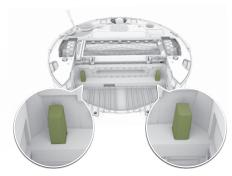
3 Wischen Sie die inneren und äußeren Sensoren auf dem Auffangbehälter mit einem sauberen, trockenen Tuch ab.
