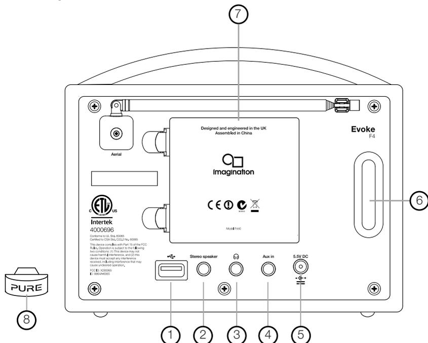
1. Connettore USB per adattatore USB Ethernet, adattatore Bluetooth o drive USB per le funzioni di registrazione/riproduzione. Utilizzato anche per aggiornare il software di Evoke quando non è disponibile una connessione Internet.
