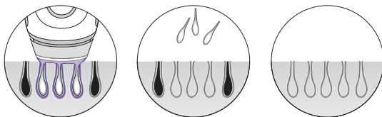
De intelligente SensoAdapt™ hudtonesensorene (2) avleser kontinuerlig hudtonen før hver lypsuls, og tilpasser automatisk lysintensiteten for å gi best mulig effekt og sikkerhet. Dette gjør det mulig å behandle egnede hudtoner, men forhindrer behandling av for mørke hudtoner.
