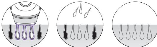
De intelligenta SensoAdapt™-hudtonsensörerna (2) läser av hudtonen kontinuerligt före varje ljuspuls och anpassar ljusintensiteten automatiskt för optimal effekt och maximal säkerhet. Detta möjliggör behandling av lämpliga hudtoner, men förhindrar behandling om din hudton är för mörk.
