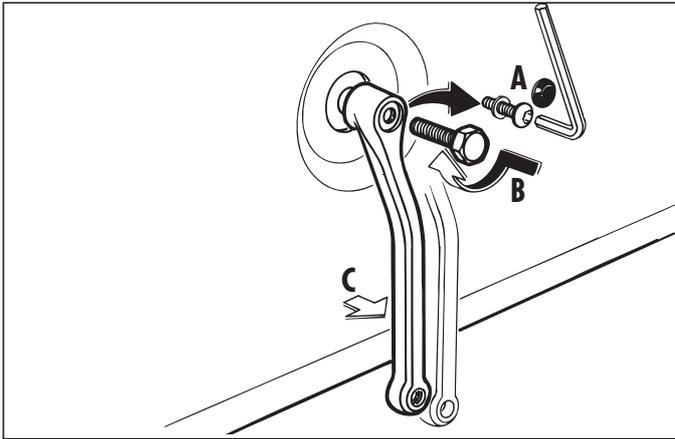
Zum Abziehen des Pedalarms entfernen Sie zuerst die Schutzkappe und Schraube (A). Halten Sie den Pedalarm fest und drehen Sie eine Schraube M12 (gehört nicht zum Lieferumfang) in die Gewindeöffnung (B). Nach einigen Umdrehungen können Sie den Pedalarm abnehmen (C).
