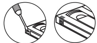
Löschschutzsperre herausbrechen (links) bzw. die so entstandene Vertiefung wieder abdecken (rechts), damit die auf der Cassette befindliche Aufzeichnung überspielt werden kann.
