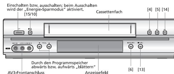
Alle Bedienelemente des Videorecorders, die die gleichen Funktionen auslösen, wie die entsprechenden Tasten der Fernbedienung, sind mit den Bezugszahlen der Fernbedienung gekennzeichnet.
