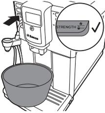
**9** Stellen Sie einen Behälter unter den Heißwasser/Dampfauslauf. Drücken Sie die OK-Taste, um den Wasserspülzyklus zu starten.
