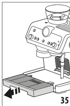
Die Abtropfschale ist mit einem Schwimmer (A14) zur Anzeige des Wasserstandes ausgestattet. Die Abtropfschale leeren und reinigen, bevor diese Anzeige aus dem Tassenrost hervortritt, andernfalls kann das Wasser über den Rand treten und die Kaffeemaschine, die Aufstellfläche oder den umliegenden Bereich beschädigen.
