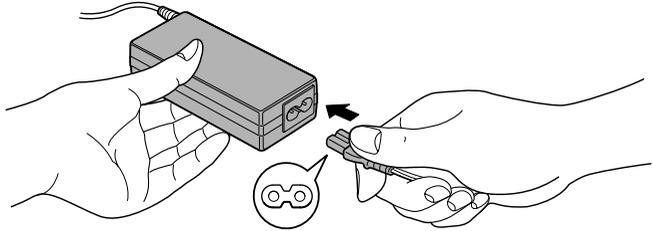
*Figura 3-1 Collegamento del cavo di alimentazione all'adattatore CA (connettore da 2 piedini)*
