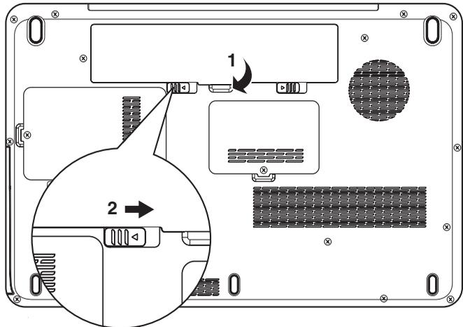
Figura 6-3 Blocco del gruppo batteria
