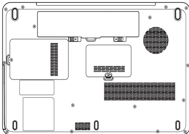
*Figura 8-3 Posizionamento del coperchio del modulo di memoria*
