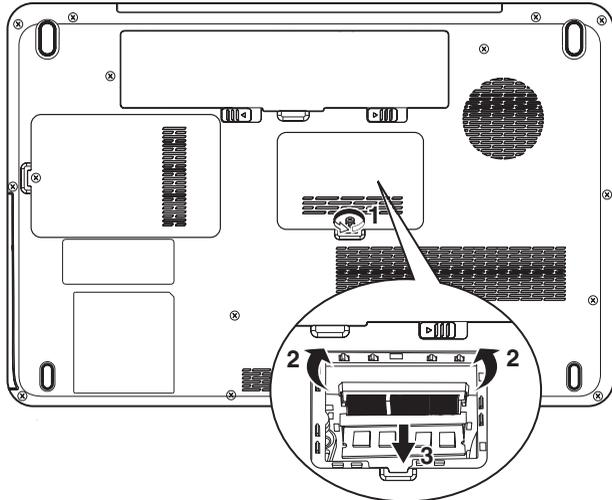
*Figura 8-2 Rimozione del coperchio del modulo di memoria*
