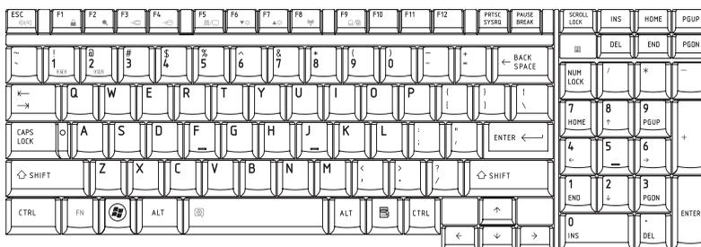
*Figura 5-1 Layout di una tastiera avanzata da 104 tasti*
