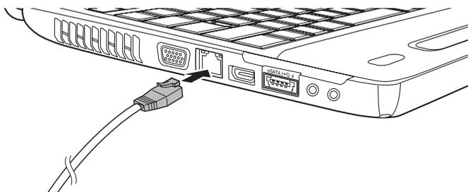
Figura 4-10 Collegamento del cavo di rete
