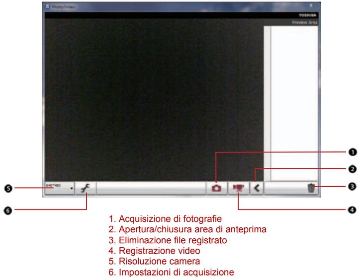
*Figura 4-9 Uso di TOSHIBA Web Camera Application*
