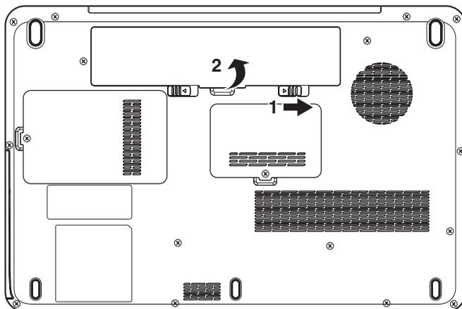
*Figura 6-2 Rilascio del gruppo batteria (2)*
