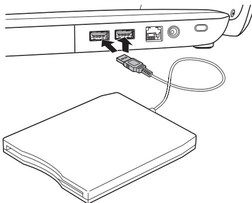
*Figura 8-5 Collegamento dell'unità dischetti USB*
