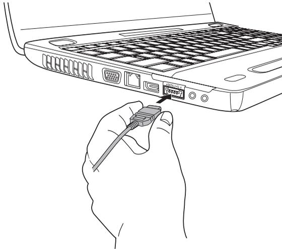
*Figura 8-6 Collegamento di un cavo eSATA alla porta combinata eSATA/USB*
