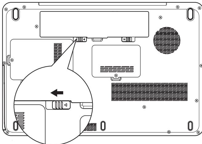
*Figura 6-1 Rilascio del gruppo batteria (1)*
