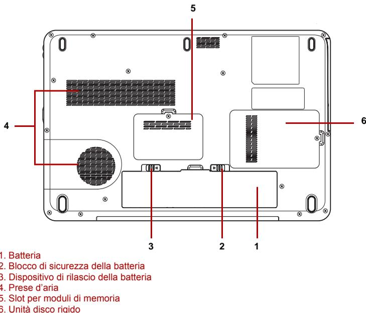
Figura 2-4 Il lato inferiore del computer
