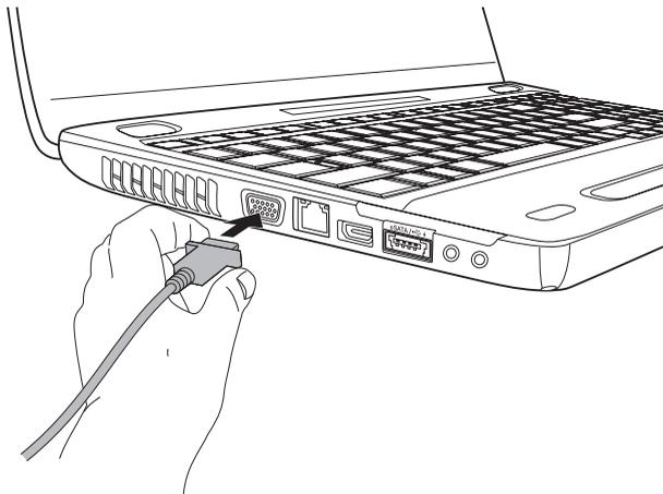
*Figura 8-7 Collegamento del cavo del monitor alla porta del monitor esterno*
