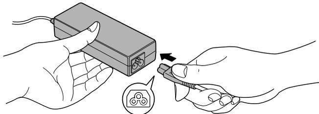
*Figura 3-2 Collegamento del cavo di alimentazione all'adattatore CA (connettore da 3 piedini)*
