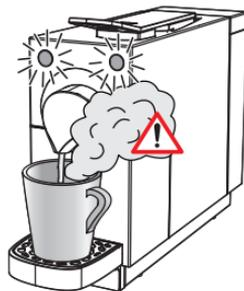
**Fuoriuscita di vapore dall'erogatore:** pericolo ustioni! Dopo alcuni secondi la pompa emette un suono. Al suo cessare, i pulsanti si spengono, l'operazione è terminata
