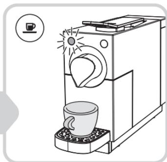
**Tenere premuto** il tasto da programmare, ad es. ☉ (min. 3 sec.), finché non inizia a lampeggiare velocemente. In seguito lampeggia lentamente (= riscaldamento)
