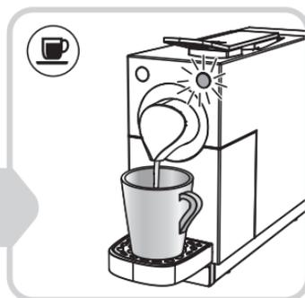
Azionare il tasto ☕ per iniziare l'operazione di risciacquo/spurgo. Dopo alcuni secondi, la pompa smette di funzionare e l'operazione è terminata
