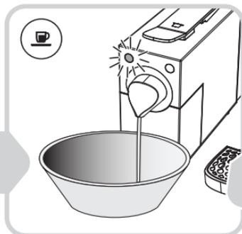
Azionare il tasto ☕⚡. Dopo l'erogazione del decalcificante lasciarlo agire per 3 minuti all'interno del circuito. Ripetere l'operazione fino a serbatoio vuoto
