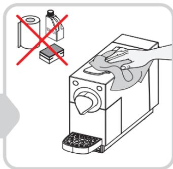
Pulire la macchina e l'erogatore con un panno umido. **Non asciugare strofinando e non utilizzare detersivi corrosivi**
