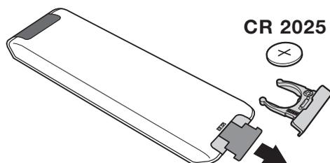
Ziehen Sie die Isolationsfolie von der Batterie ab, um die Fernbedienung zu aktivieren.
