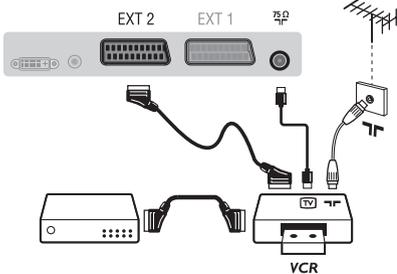
Podłączyć magnetowid wg schematu. Stosować kabel typu Euro o dobrej jakości.
