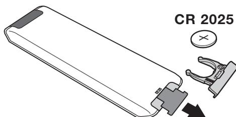
Dra bort den isolerande lappen från fjärrkontrollens batterilucka för att aktivera fjärrkontrollen.
