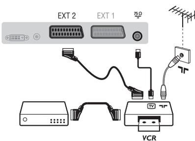
Realice las conexiones indicadas enfrente. Utilice un cable Euroconector de buena calidad.
