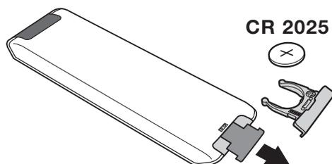
Odstráňte izolačný pásik z batérie, čím aktivujete diaľkové ovládanie.
