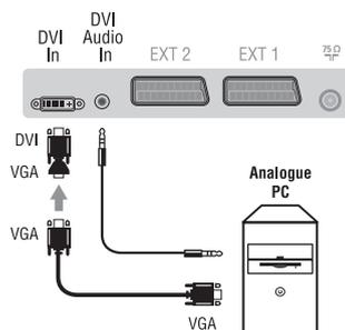
La resolución óptima de la pantalla se obtiene configurando el ordenador en 1024 x 768, 60 Hz.
