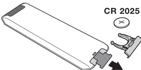
Verwijder de beschermfolie van de batterij om de afstandsbediening te activeren.
