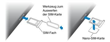
Öffnen des SIM-Fachs: Führen Sie das Auswerfwerkzeug (separat erhältlich) gerade in das Loch des SIM-Kartenfachs ein und drücken Sie so lange, bis das Fach herausspringt. Ziehen Sie das SIM-Fach heraus, um die SIM-Karte zu installieren bzw. auszutauschen. Wenn Sie das Werkzeug zum Auswerfen der SIM-Karte nicht zur Hand haben, können Sie eine aufgebogene Büroklammer verwenden.
