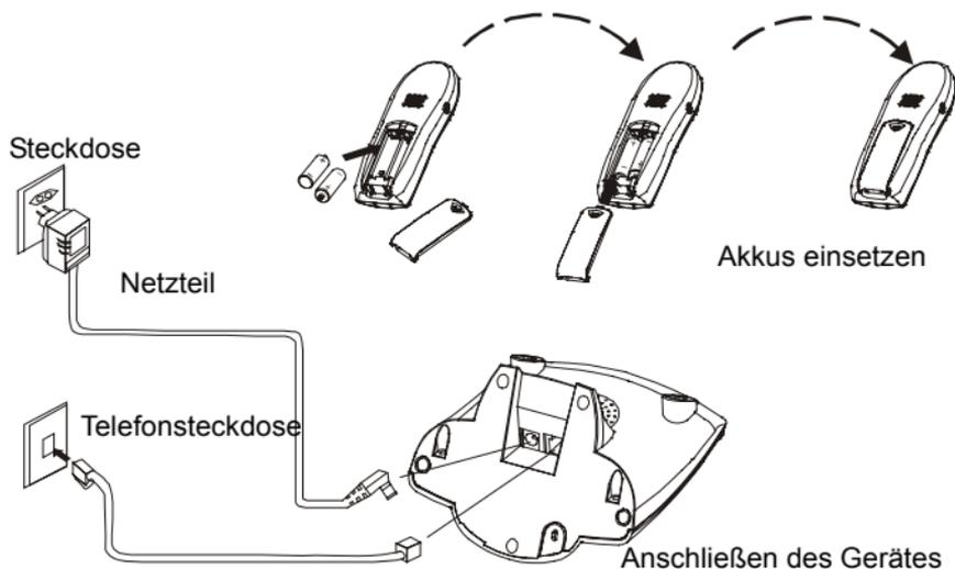
1. Netzteilkabel in Basisstation einstecken.
