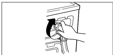
4. Resserrer le tuyau d'arrivée d'eau.
