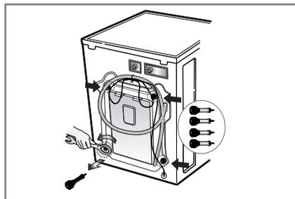
1. Les 4 vis spéciales sont serrées pour prévenir tous dommages internes pendant le transport. Avant de faire fonctionner la machine à laver, enlever les vis ainsi que les rondelles en caoutchouc.
