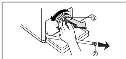
2. Retirer le bouchon de purge (2), laisser l'eau s'écouler. Utiliser un récipient pour empêcher l'eau de se répandre sur le sol. Lorsque l'eau ne s'écoule plus, dévisser le filtre de la pompe (3) en le faisant tourner vers la gauche.
