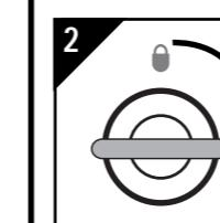
Gebruik de sleutel om de sleutelschakelaar te ontgrendelen.
