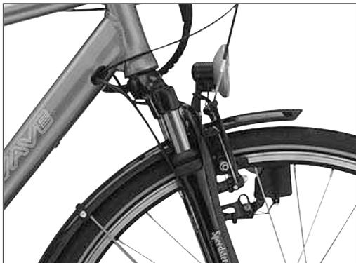
Da der Strombedarf der Fahrradbeleuchtung sehr gering ist, würde eine nicht abgeschaltete Beleuchtung 2-3 Tage leuchten. Darüber hinaus verhindert die Schutzelektronik eine Tiefentladung der Batterie, falls das Licht versehentlich angeschaltet bleibt.
