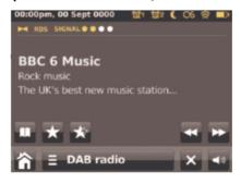
Ligne d'en-tête : date, heure, alarme, fonction "Sleep", état de la connexion réseau
