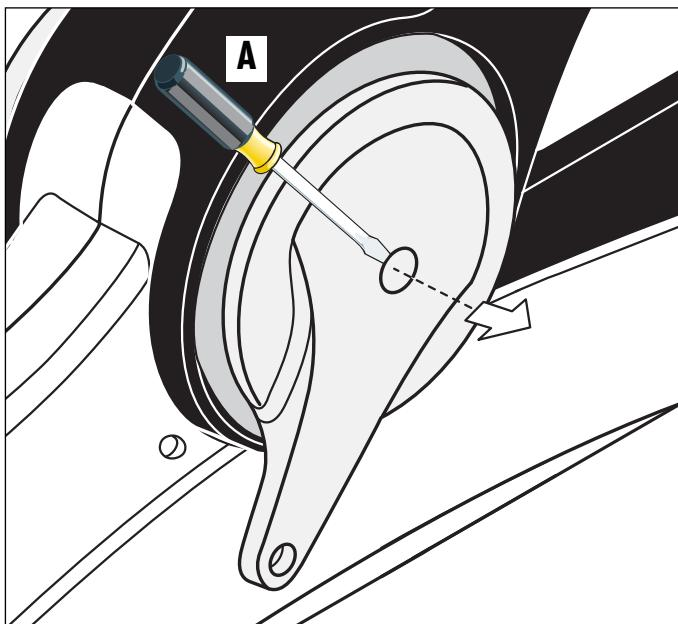
Zum Abziehen des Pedalarms entfernen Sie zuerst die Schutzkappe und Schraube (A). Halten Sie den Pedalarm fest und drehen Sie eine Schraube M12 (gehört nicht zum Lieferumfang) in die Gewindeöffnung (B). Nach einigen Umdrehungen können Sie den Pedalarm abnehmen (C).
