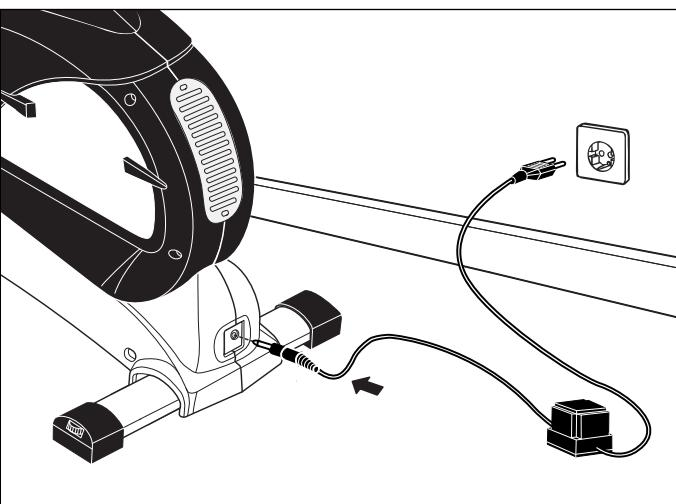
**D** Bei Geräten mit Netzteil: **Achtung!** Betrieb nur mit mitgeliefertem Original-Netzteil oder Original-KETTLER-Ersatzteil (siehe Ersatzteilliste) zulässig. **Ansonsten Gefahr der Beschädigung.**
