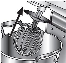
Inserire gli utensili nel foro del braccio motore e fissarli
