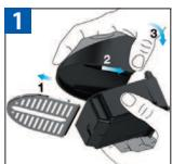
Pour assembler le support de tasse avec le bac d'égouttage: enlevez la grille, placez les l'un contre l'autre. Clipsez le bac d'égouttage dans l'encoche du support de tasse.
