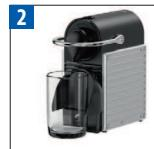
Entfernen Sie den Wassertank. Schließen Sie den Hebel. Stellen Sie einen Behälter unter den Kaffeeauslauf.
