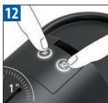
Pour sortir du mode détartrage, appuyez sur les deux boutons simultanément pendant une seconde.
