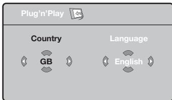
Wenn das Menü nicht angezeigt wird, halten Sie die Tasten **Δ-** und **Δ+** des Fernsehgeräts 5 Sekunden lang gedrückt. Daraufhin wird das Menü angezeigt.
