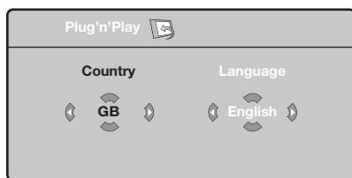
Gdy po włączeniu odbiornika nie wyświetli się menu, naciśnij przyciski  $\Delta$ - i  $\Delta+$  odbiornika i przytrzymaj je wciśnięte przez 5 sekund.
