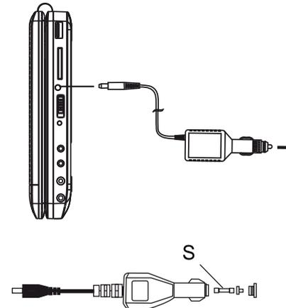
Ziehen Sie den Kfz-Adapter ab und schalten Sie das Gerät aus, bevor Sie die anderen Kabel anschließen.
