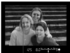
Collimateur autofocus Voyant de confirmation de mise au point
