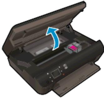
2. Entfernen Sie das eingeklemmte Papier aus dem Drucker.
