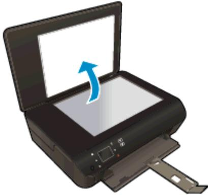
2. Legen Sie das Original mit der bedruckten Seite nach unten so auf das Scannerglas, dass es vorne rechts anliegt.
