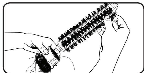
4. Verwenden Sie zum Reinigen der Seitenbürste einen kleinen Kreuzschlitzschraubendreher, um die Schraube in der Mitte zu entfernen. Entnehmen Sie die Bürste, reinigen Sie sie, und setzen Sie sie wieder ein.
