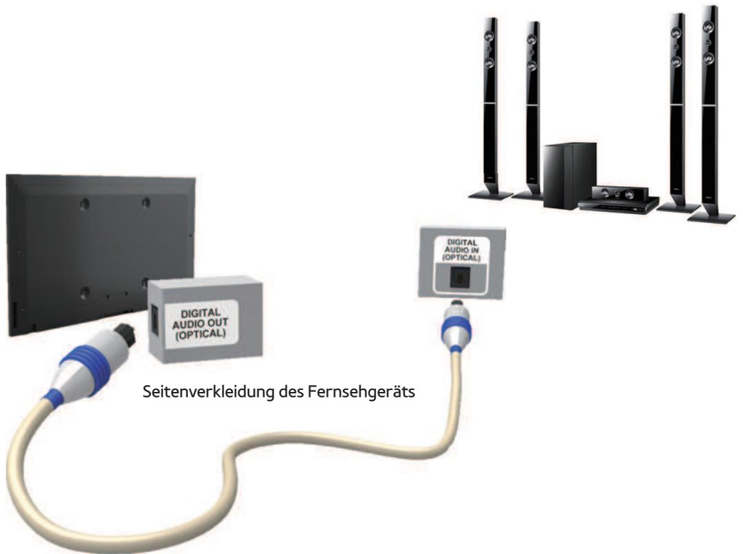
Seitenverkleidung des Fernsehgeräts
