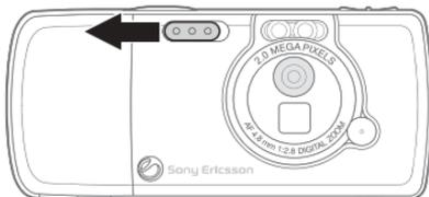
Öffnen Sie im Standby-Modus die Linsenabdeckung, um die Kamera zu aktivieren.
