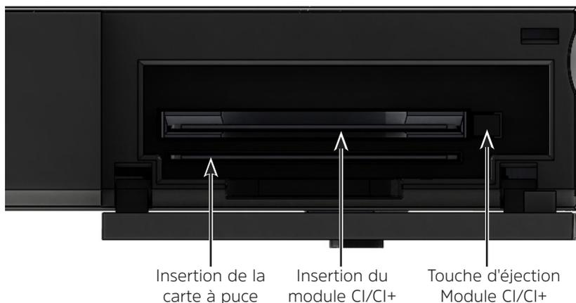
**i** Insérez la carte à puce avec les contacts dorés positionnés vers l'avant et vers le bas dans la fente d'insertion de la carte à puce.
