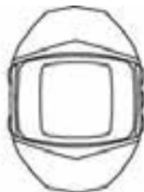
Der **WearLink Textil-Sender** sendet die Herzfrequenz-Signale EKG-genau an den Armbandempfänger. Der WearLink Sender besteht aus der Sendeeinheit und dem elastischen Gurt.
