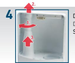
4 Dampfkopf entfernen
