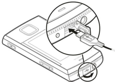
Ouvrez le cache du connecteur USB et connectez le câble USB à l'appareil.
