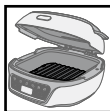
Der schwarze Reflektor muss korrekt platziert und am Boden des Gerätes befestigt sein.
