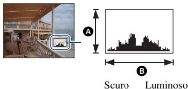
Un istogramma è un grafico che indica la luminosità di un'immagine. Premere più volte ▲ (DISP) sul tasto di controllo per visualizzare l'istogramma sullo schermo. Il display del grafico indica un'immagine luminosa quando è asimmetrico sul lato destro e un'immagine scura quando è asimmetrico sul lato sinistro.
