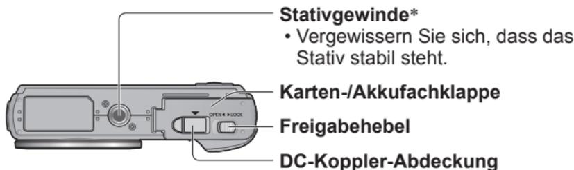
\* Befestigen Sie kein Stativ, dessen Schraube eine Länge von 5,5 mm oder länger besitzt. Dadurch kann dieses Gerät beschädigt werden.
