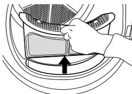
Drücken Sie die Taste, um das Türsieb zu öffnen. Entfernen Sie die Flusen im Inneren. Schließen Sie den Filter und setzen Sie ihn in der richtigen Richtung ein, so dass er vollständig in der Filterkammer integriert ist.
