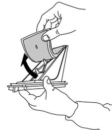
Bringen Sie den Filterschaumstoff am Filtersieb an. Reinigen Sie die Filterkammer des Trockners vorsichtig mit einem feuchten Tuch oder mit einem Staubsauger. Bodensieb wieder einsetzen. Klappen Sie den Filtergriff nach unten und schließen Sie die Bodenklappe.
