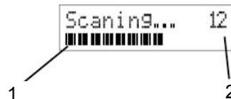
Nach Beendigung des Sendersuchlaufs wird die erste Station in numerischer und dann in alphabetischer Reihenfolge wiedergegeben. Die gefundenen Sender werden gespeichert und stehen auch nach dem Ausschalten und erneutem Wiedereinschalten zu Verfügung.
