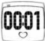
2. Le chronomètre démarre après quelques secondes. Le contour du symbole en forme de coeur clignote jusqu'à détection de votre fréquence cardiaque (cette opération ne devrait pas prendre plus de 15 secondes).
