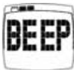
2. **BEEP** (BIP) apparaît alors à l'écran et **ON** ou **OFF** se met à clignoter. Appuyez sur le bouton pour sélectionner **ON** (activer l'alarme), ou **OFF** (désactiver l'alarme).
