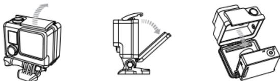
2. Öffnen Sie die Seitenklappe der Kamera und legen Sie die microSD-, microSDHC- oder microSDXC-Karte (separat erhältlich) in den Kartensteckplatz ein. Es ist eine microSD-Karte mit einer Geschwindigkeit der Klasse 10 oder UHS-1 erforderlich.
