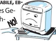
**STELLEN SIE DAS GERÄT NICHT IN DER NÄHE** anderer Wärmequellen auf. Um eine ausreichende Luftzirkulation zu gewährleisten, muss der freie Raum über dem Gerät mindestens 30 cm betragen. Der Raum unter, über und um das Gerät muss frei sein, um eine ausreichende Luftzirkulation zu gewährleisten. Die Mikrowelle darf nicht in einem Schrank untergebracht werden.
