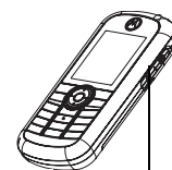
Connettore del caricabatteria Consente di collegare il caricabatteria.
