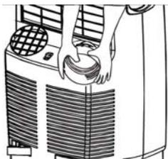
Fixez à présent le tube d'évacuation d'air assemblé au climatiseur.
