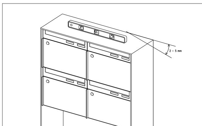
Avec les systèmes à toit plat, l'eau ne peut pas s'écouler (ne donne pas droit à une réclamation). Selon les dimensions du système, celui-ci peut si désiré être inclinés de 2 à 5 mm sur le côté. Le système ne doit jamais être incliné vers l'arrière: dans un tel cas, les clapets ne pourraient pas se refermer complètement. L'eau pourrait alors s'infiltrer à l'intérieur et mouiller le courrier.
