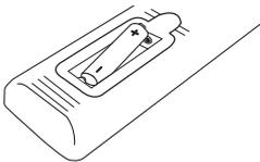
Togliere il coperchio della batteria sul retro del telecomando, e montare due batterie R03 (taglia AAA) con i punti  $\oplus$  e  $\ominus$  esattamente corrispondenti.
