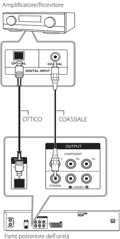
1. Collegare uno dei jack del registratore di uscita audio digitale DIGITAL AUDIO OUTPUT (OTTICA o COASSIALE) al corrispondente jack di ingresso dell'amplificatore. Usare un cavo audio opzionale digitale (ottico o coassiale).
