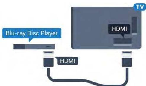
Wenn der Blu-ray Disc-Player über EasyLink HDMI-CEC verfügt, können Sie den Player mit der Fernbedienung des Fernsehers steuern.
